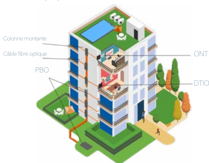
ONT : Optical Network Terminal DTIO : Dispositif de Terminaison Intérieure Optique
